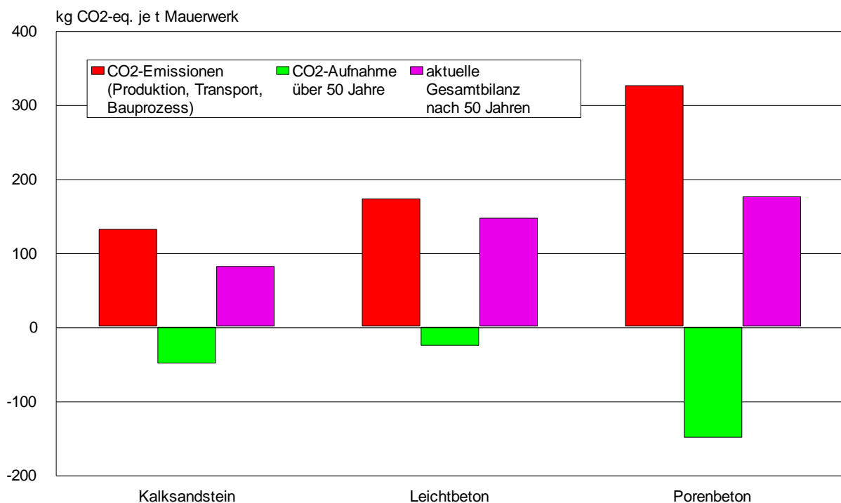
Abbildung 2: Emission von CO 2 -eq. bei Herstellung, Transport und Verarbeitung von Mauerwerksprodukten sowie die anschließende Recarbonatisierung über 50 Jahre
